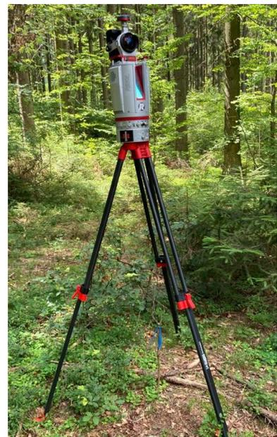
Riegl VZ 400i auf der ersten Scanposition gekennzeichnet durch den Mittelpunkt des Inventurpunktes.
