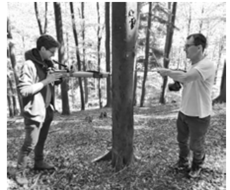
Die Bohrkernanalysen und Holzdicke-messungen werden mit den Laserscanningdaten verknüpft.
